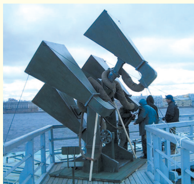
Рис. 1. Звукоулавливатель времен Великой Отечественной войны для обнаружения вражеских самолетов, по-видимому, в осажденном Ленинграде.
